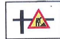
a46 - Presemnalizare Lucrări pe străzi
